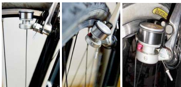
Adaptateur de socle cantilever gauche avec rotule ajustable. Situation de montage : Position nominale, position ouverte, en mode de fonctionnement position fermée
