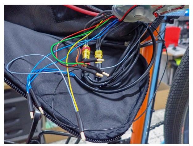
Câble du potentiomètre passant du compartiment de la batterie au côté du contrôleur
